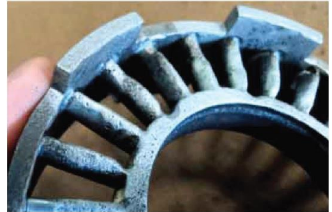
Традиционная технология Износ после 300 часов.
